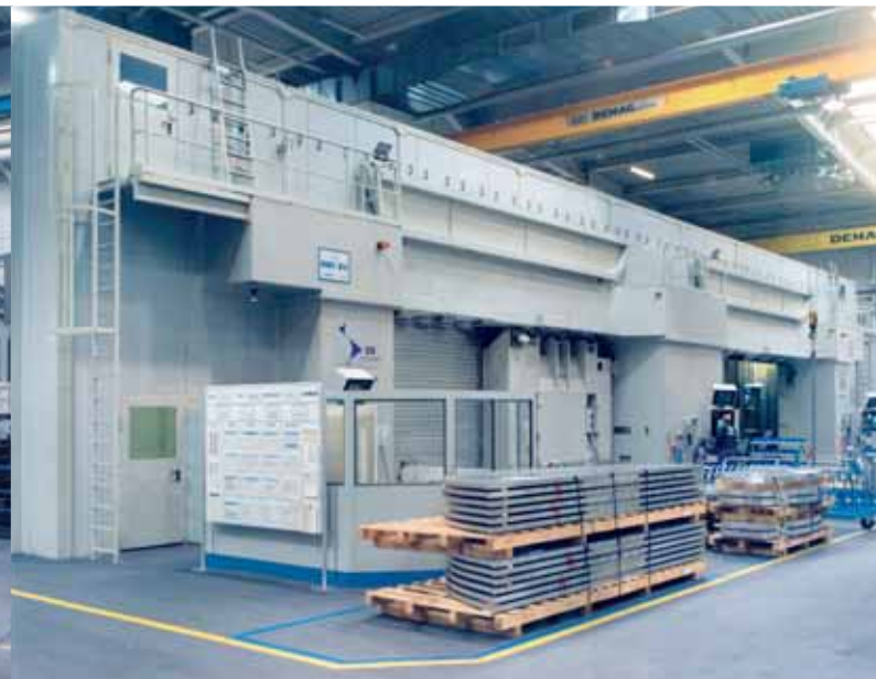
Auch Maschinen vom Typ ACM sind in Varel im Einsatz. Nach der Überzeugung von Betreiber und Hersteller ist dies das größte vierspindelige BAZ in Europa.
