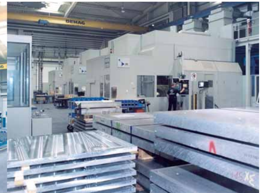
Drei ECOSPEED 2500 sind über zwei Rüstplätze und sechs Puffer verkettet.
