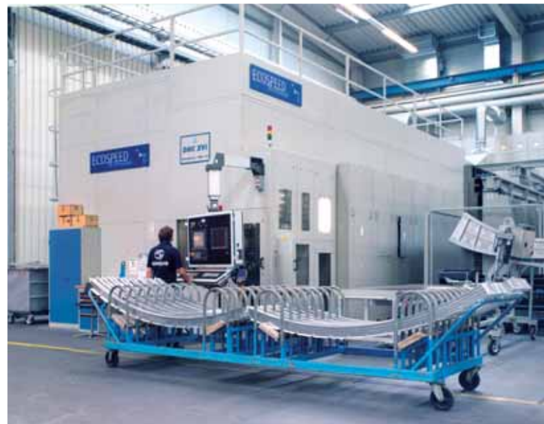
Auf der ECOSPEED 2600 werden Strukturbauteile von bis zu 7.000 mm Länge bearbeitet.
